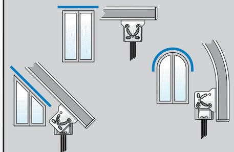
L'arresto 4116 è dotato di una piastra di ancoraggio al profilo in alluminio che permette ad esso di inclinarsi sino a raggiungere un orientamento a 90°, quindi parallelo al profilo velcro per installazioni su una volta a semicerchio.
